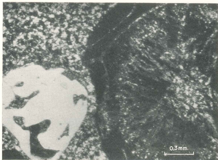
Fig. 10 — Fotomicrografia de riolito, com fenocristal de quartzo, observando-se esferulito resultante de intercrescimento radial de quartzo e feldspato. O esferulito apresenta um envoltório constituído de material criptocristalino (mais escuro). O quartzo, que tem as bordas corroídas, inclui porções, de formato irregular, da matriz microcristalina. Nicóis +.
