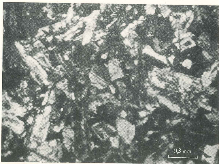
Fig. 15 — Fotomicrografia de andesito, mostrando a textura felty da matriz, constituída de plagioclásio ripiforme, em cujos interstícios cristalizou clorita. Nicóis +.
