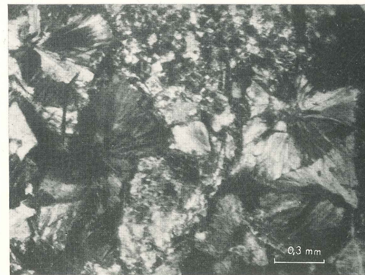
Fig. 13 — Fotomicrografia de microgranito esferulítico. A matriz é microcristalina, constituída de quartzo e feldspato. Nicóis +.
